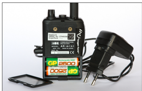
Bild 3: Das mitgelieferte Steckernetzteil lädt zwei Akkumulatoren im Gerät.
