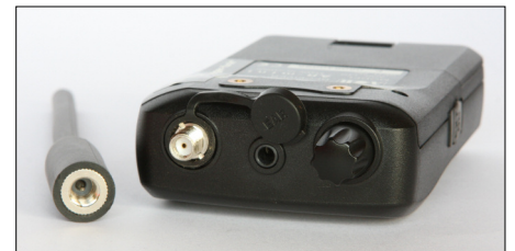
Bild 2: Oben liegen Anschlussbuchsen für die Antenne und einen Ohrhörer.
