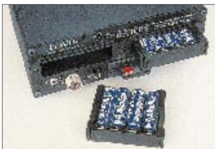
Auf der Rückseite des HF-150E finden sich die Anschlüsse, um das volle Potential eines der kleinsten auf dem Amateurmarkt erhältlichen Kommunikationsempfänger zu nutzen. Für Empfangsbetrieb unterwegs läßt sich der HF-150E auch mit Batterien betreiben, die in zwei Fächern auf der Rückseite des Empfängers Platz finden. Fotos: hku
