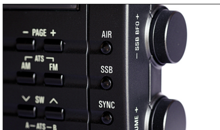
Bild 5: Als Besonderheiten bietet der PL-660er SSB und Sync mit wählbaren Seitenbändern sowie das VHF-Flugfunkband.
