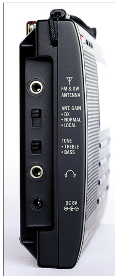
Bild 3: Anschlussbuchsen, Antennenabschwächer, Tonblende auf der linken Geräteseite
