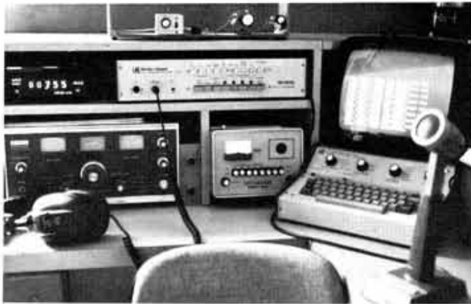
Trio 9R59 mit QRG-Digi und RTTY-Anlage (Konverter MSK-10, Video-Konverter RVD 100 & mit eingebauter Verteilschleife, Keyboard DKB 2010 und TV-Display).
