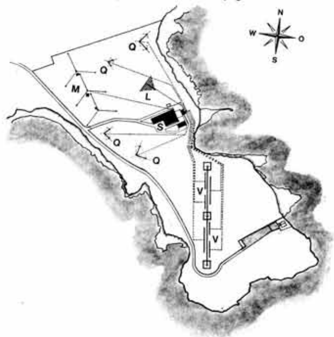
Bild 2: Sendestation Cyclops. Q = Quadratantenne, L = Logarithmisch-periodische Antenne, V = Vorhangantenne, M = Dreimast-Mittelwellenantenne, S = Sendergebäude
