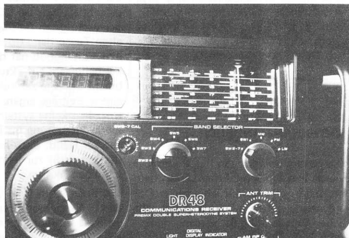
Abstimmung und Anzeige beim DR28. Im Gegensatz zum DR48 ist die Digitalanzeige für alle Bereiche brauchbar. Skala und Digitalanzeige des DR 48
