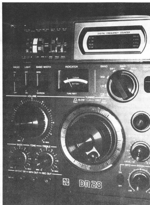
Abstimmung und Anzeige beim DR28. Im Gegensatz zum DR48 ist die Digitalanzeige für alle Bereiche brauchbar. Skala und Digitalanzeige des DR 48
