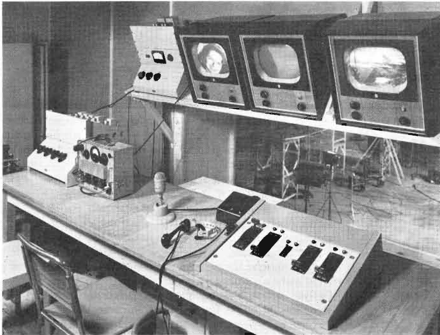
So einfach war Technik damals: Das Regiepult des Münchensteiner Versuchssenders, Marke Eigenbau.
