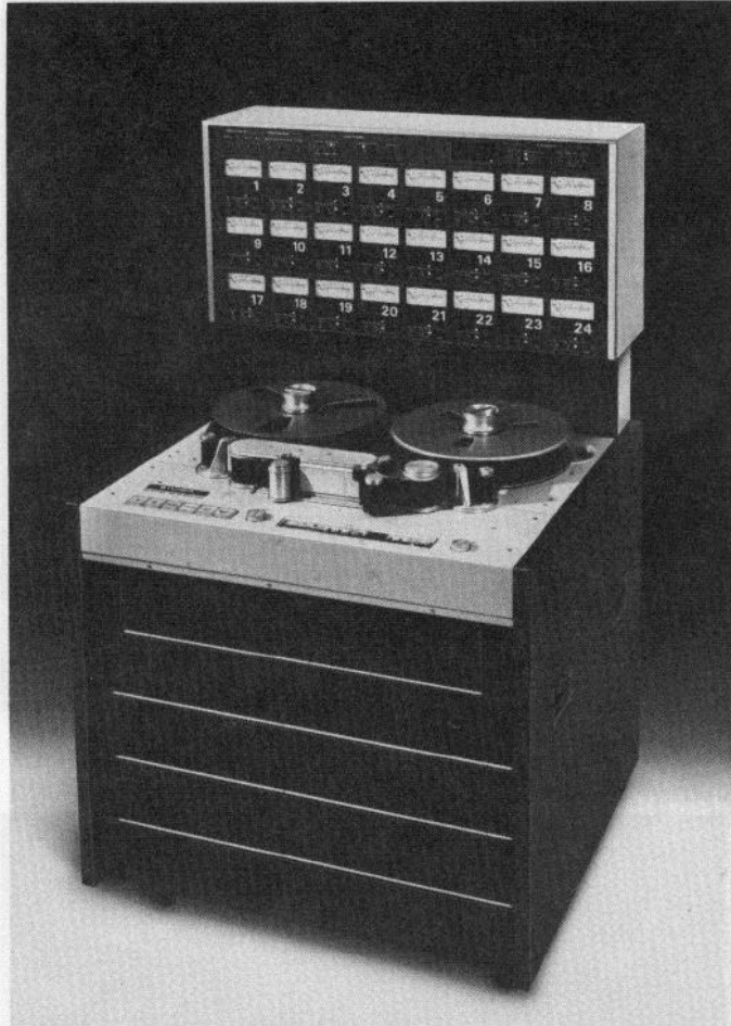
Für die Produktion von moderner Unterhaltungsmusik heute unabdingbar: die 24 Spur-Maschine („Studer“), wie sie seit neuestem auch im Studio 7 vorhanden ist.
