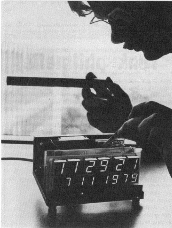
11 Uhr 29 und 21 Sekunden zeigt diese Langwellenuhr mit Mikrocomputer. Laut LED-Anzeige wurde das Bild am 7.11.1979 aufgenommen. (Foto: Siemens)
