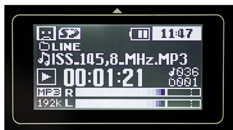
Bild 4: Das Display zeigt die Aufnahmeparameter wie die sekundengenaue Aufnahme- bzw. Wiedergabezeit. Der Dateiname ist nur extern editierbar.
