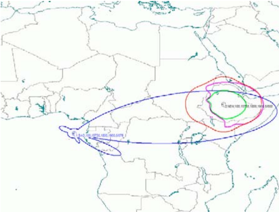
Abbildung 20: Links ein Sender der IBB (VoA), der zwischen 18 und 19 Uhr UTC auf 15730 kHz nach Äthiopien sendet. Dort jedoch betreibt die Regierung einen Störsender, dessen Rauschen das ganze Land mit einem Fußabdruck in Form eines UFOs erfasst. Die darin enthaltenen Umriss markieren einen Störabstand von 17 dB (innen) bzw. nur 7 dB (außen). Durch die große Entfernung und die hohe Frequenz nutzt die IBB die „Tote Zone“ des Jammers, dessen Störungen im Zielgebiet sich daher in Grenzen halten.
