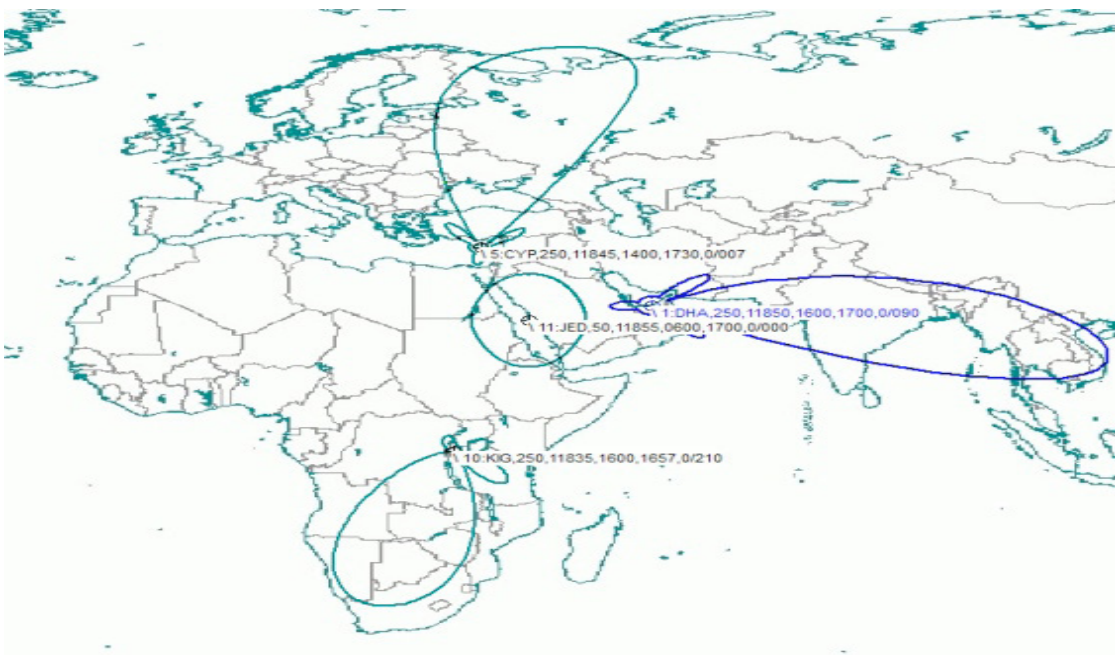
Abbildung 25: Die Planung dieser drei Sender ist hinsichtlich Frequenzabständen und Senderrichtungen für die jeweiligen Zielregionen perfekt.
