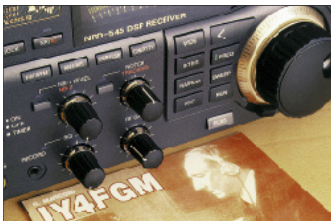
Ob Marconi die DSP-Empfänger der jüngsten Generation gefallen hätten? Der NRD-545 vereint ein herkömmliches Bedienungskonzept mit modernster DSP-Technologie. Das digitale Notchfilter läßt sich manuell einstellen und durch eine Automatik ergänzen.
