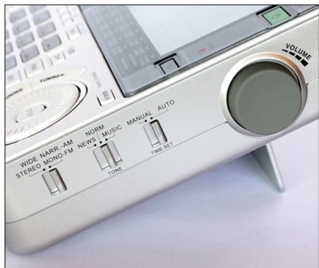
Bild 3: Tonblende, Bandbreitenfilter und Lautstärkesteller liegen auf der rechten Gehäuseseite.
